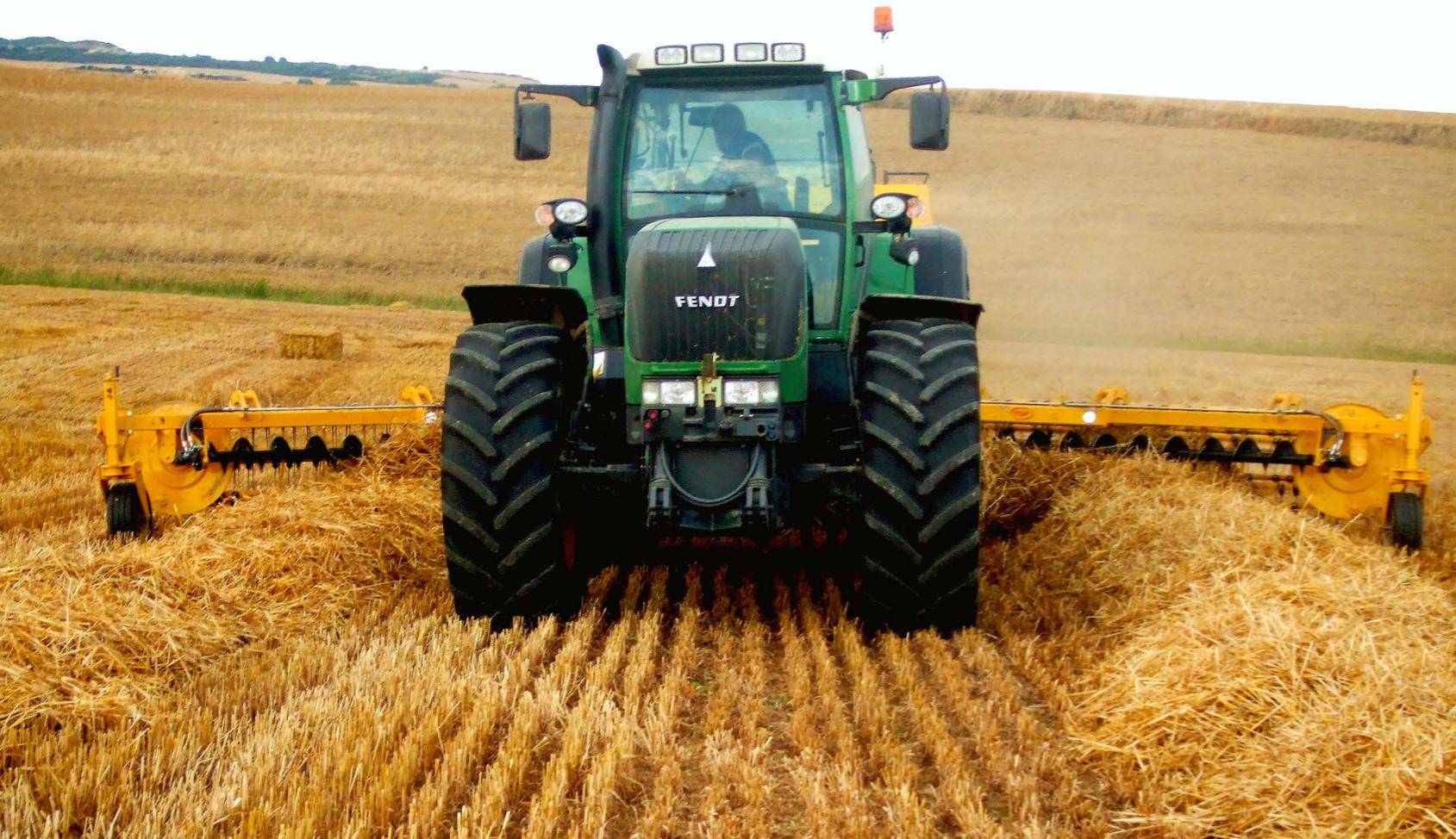
El rastrillo hilerador V-9100 acoplado a la empacadora es el complemento ideal para sacarle el máximo partido, permite trabajar con una anchura de 9'10 metros que son suficientes para coger dos hileras de una cosechadora de 7'50 metros de una sola pasada.
