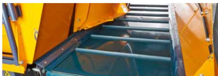
La velocidad de la cinta es ajustable para un control perfecto de la distribución. Gracias a la cinta situada en la parte trasera de la máquina, la distribución a la izquierda o a la derecha se realiza cualquiera que sea la configuración de las explotaciones e igualmente en los pasillos de alimentación no pasantes.
