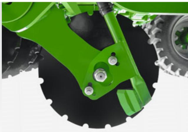
Disco FerTeC delante del compactador de neumáticos
