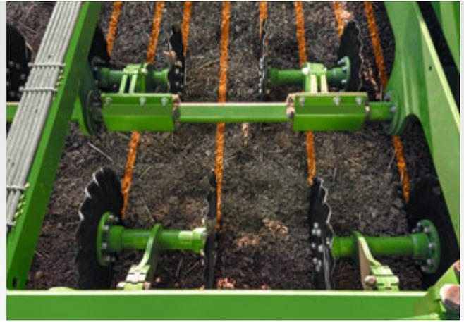
Tratamiento en franjas mediante los discos ondulados Minimum TillDisc
