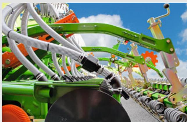
Sensor para la detección del flujo de semillas en el disco de siembra
