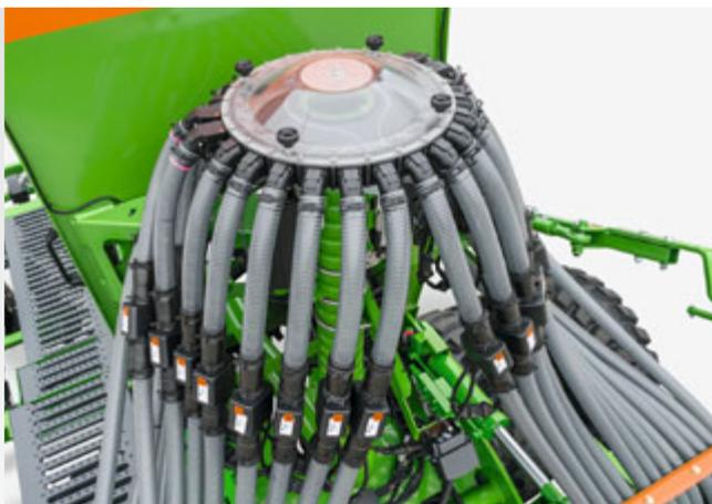
Cabezal distribuidor de segmentos
