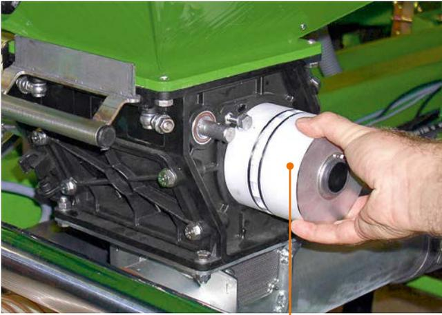
El rodillo dosificador se puede cambiar rápidamente en el lado izquierdo de la máquina
