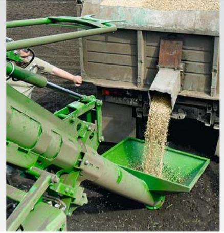
Para el llenado de la tolva de semillas y de abono, AMAZONE ofrece un sinfín de llenado de accionamiento hidráulico. Permite reducir los tiempos de llenado hasta llegar a tan solo ocho minutos, con el consiguiente aumento de productividad de la máquina. El tornillo sin fin de llenado se encuentra disponible para todas las Primera DMC 6000-2/6000-2C y 9000-2/9000-2C.
