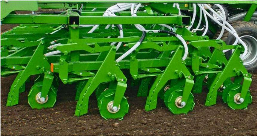
La disposición de las unidades de reja en 4 hileras sucesivas de travesaños longitudinales las mantiene bien separadas entre sí. De esta manera se garantiza que la paja pueda pasar fácilmente.
