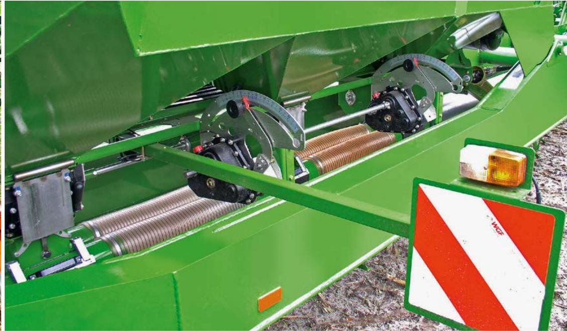
Depósito a presión con 3 cámaras El tren de engranajes Vario permite cantidades de siembra de 2 a 400 kg.
