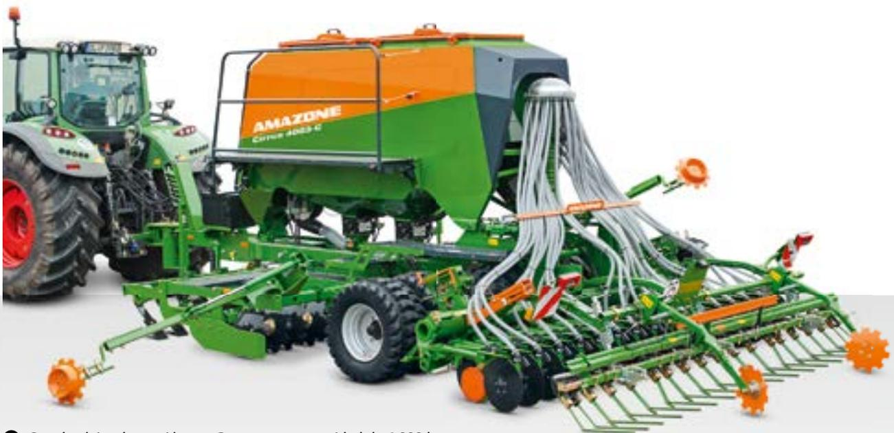
⊕ Con depósito de presión con 2 senos con capacidad de 4.000 l: para semillas y abono
