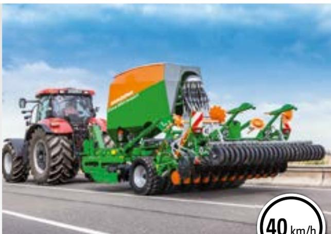
❶ «La Cirrus está equipada de serie con un freno neumático con buena capacidad de frenado. ¡Ejemplar! Aún mejor: Esto significa que la máquina también se puede desplazar por carretera a 40 km/h con el depósito de semillas lleno.»
