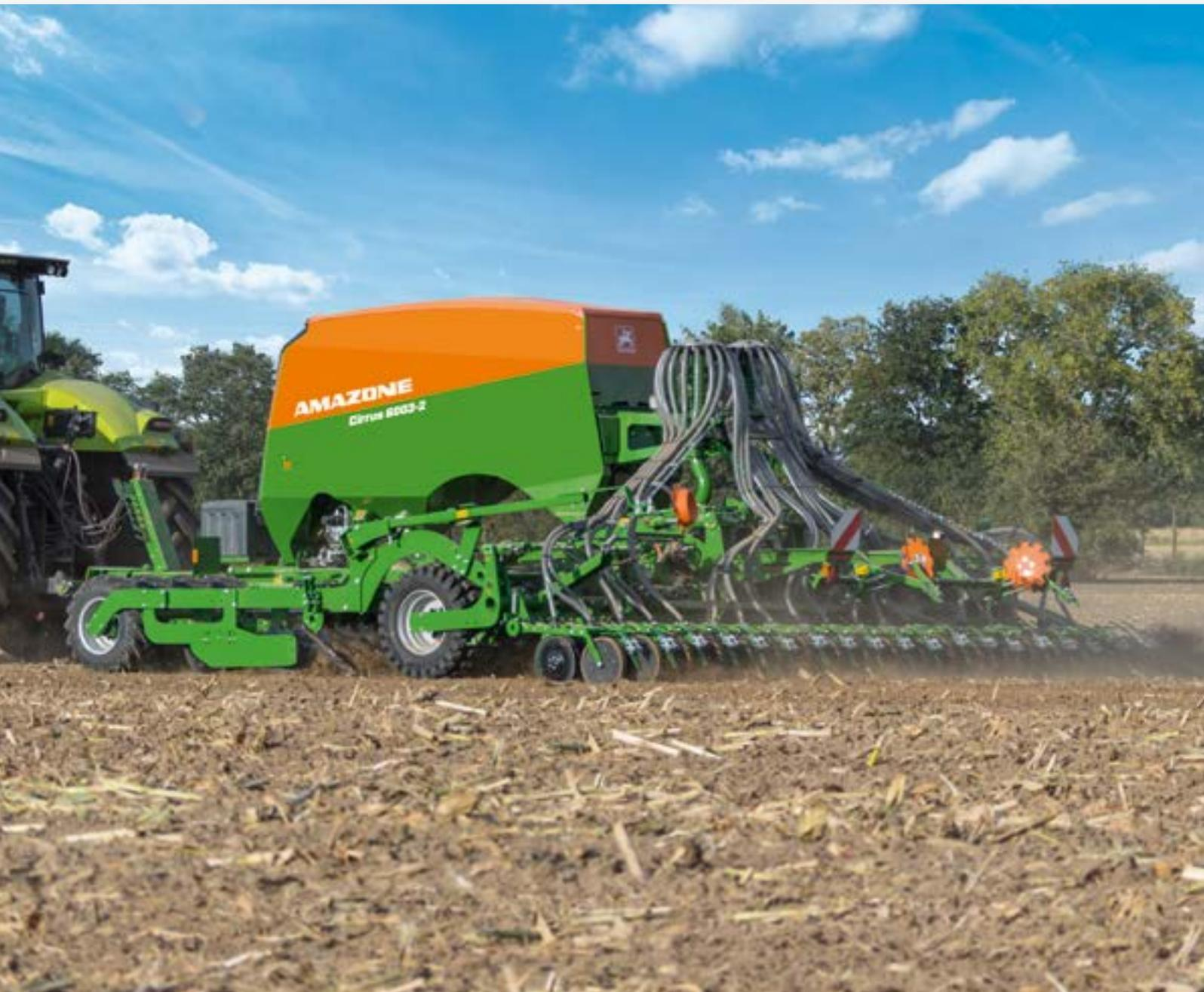
❗ «Se ha cambiado la forma del tubo de semillas en el disco para colocar las semillas con mayor precisión en el fondo del surco. Esto funciona perfectamente: al destapar las semillas no encontramos nada por encima. Prácticamente todas las semillas se encontraban en el fondo del surco de siembra, por el que discurre el agua».
