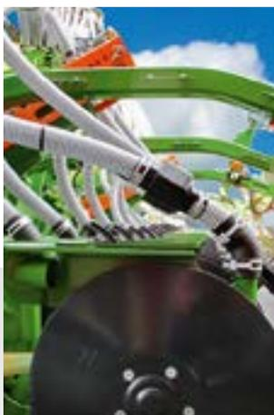
Sensor para la detección del flujo de semillas en el disco de siembra
