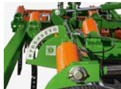
❗ «La escala semicircular grabada con láser para la nivelación es estupenda». (profi – Ensayo práctico «Cultivador equipado parte 2» · 06/2017)
