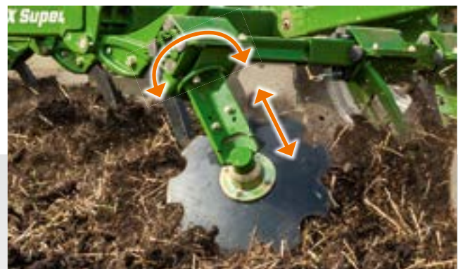
El elemento marginal: ajustable en altura e inclinación de forma independiente
