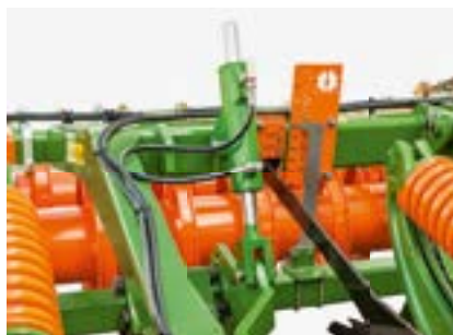
Cilindro para el ajuste de profundidad de la unidad de nivelación
