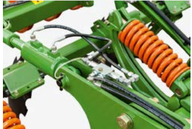
Cilindro para el ajuste de profundidad del panel de púas
