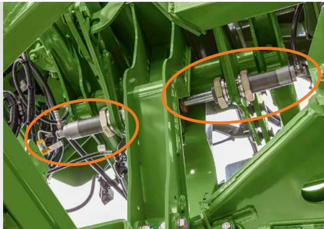
El SwingStop dispone de dos cilindros hidráulicos activos en la sección central de las barras
