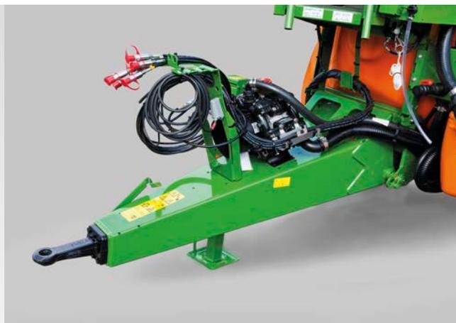
Suspensión inferior con argolla de tracción y pie de apoyo mecánico
