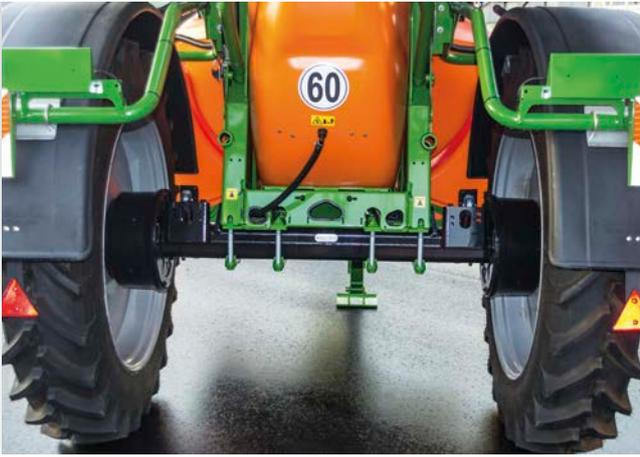
Eje fijo con anchos de vía de 1,50 m a 2,25 m
