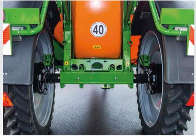
Eje regulable con ajuste continuo del ancho de vía de 1,50 m a 2,25 m
