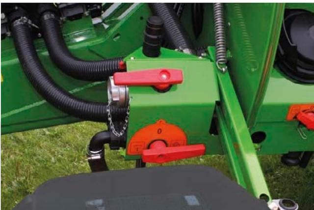
La conexión del inyector del UX Special permite capacidades de llenado de hasta 500 l/min.
