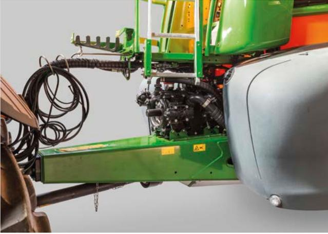
El sistema de doble bomba del UX Super proporciona caudales de hasta 520 l/min
