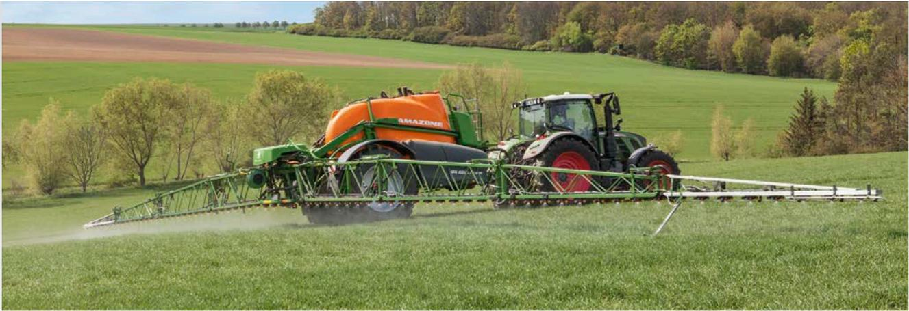
ContourControl con ajuste del ángulo de las barras hacia abajo
