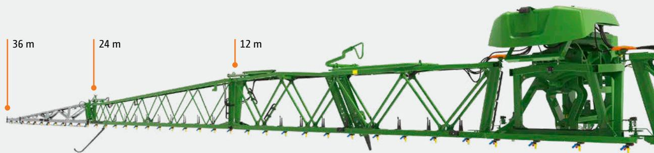
Barra Super-L3 de 36 m, reducible a 24 m y 12 m
