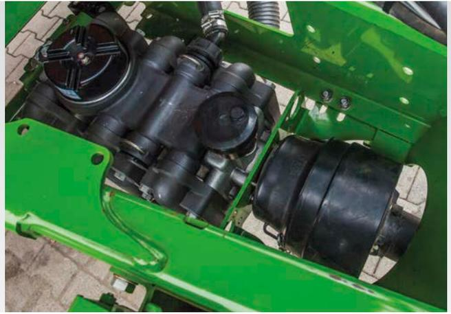
El UX Special puede equiparse con bombas con un caudal de 260 l/min o 380 l/min.
