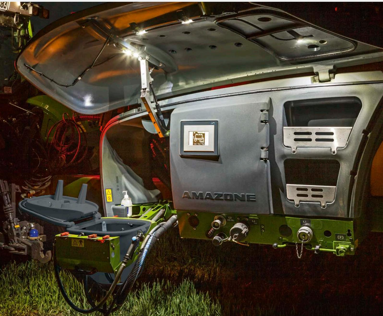
✔ SmartCenter con paquete Comfort plus e iluminación LED, protegida de forma segura bajo la cubierta
