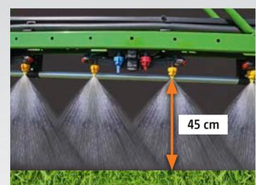
Boquillas 80°: Distancia entre boquillas 25 cm
