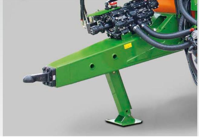
El accionamiento hidráulico de la bomba funciona independientemente del número de revoluciones del motor, con un número de revoluciones suave y constante.
