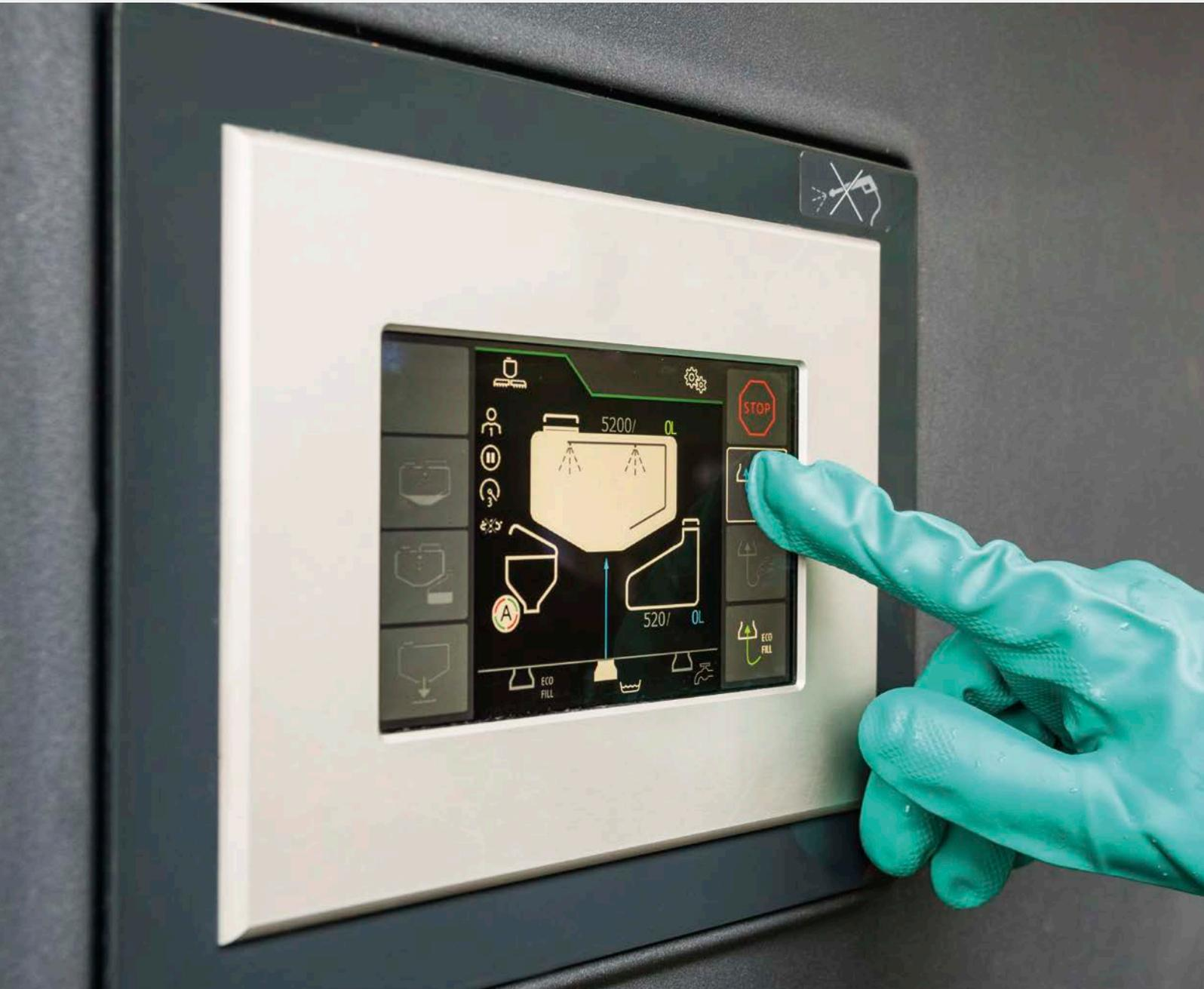
❗ «El usuario es guiado a través de los menús para llenar el depósito de agua limpia, el depósito de mezcla y la compuerta de llenado mediante gráficos muy claros de depósitos, conexiones y circuitos de líquidos. Único»
