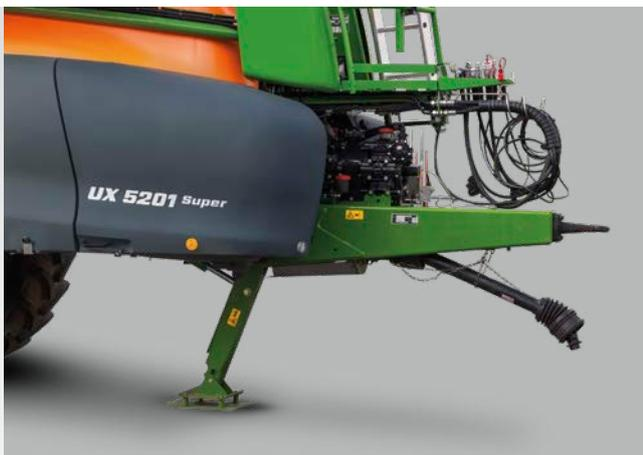
Suspensión superior con argolla de tracción y pie de apoyo hidráulico
